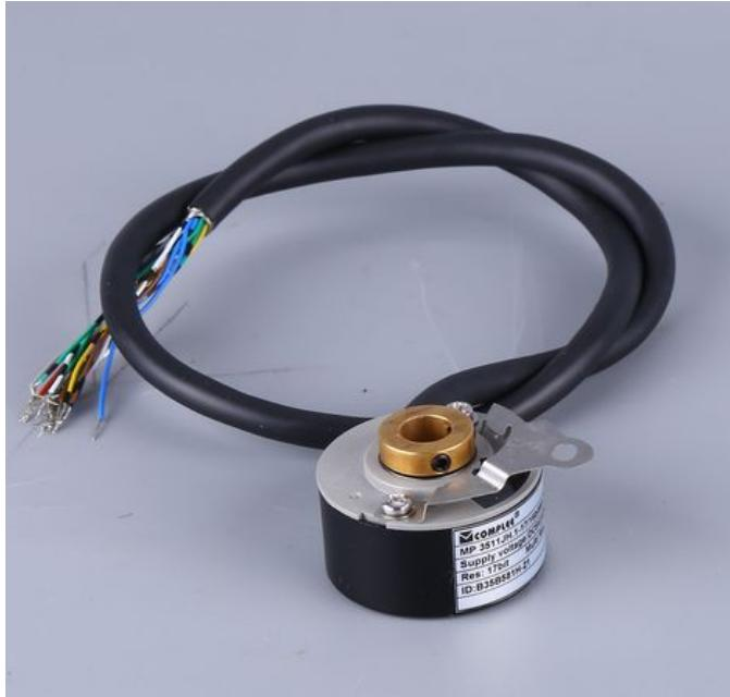
值编码器和增量式编码器有何区别？1：首先值编码器的码盘和增量型编码器的码盘存在差异，增量型编码器的码盘是在同一个圆周上有固定数量的光栅，通过光栅切割光线产生一定数量的脉冲（每圈上光栅的数量即为编码器所谓的分辨率）；而值编码器则在同样的码盘上在不同的圆周上有不同数量，不同间隔的光栅，即当码盘停在某个位置时，可以通过码盘上各圆周上的是否透光组合成固定的位置，经过输出线后显示的是一个固定的数字。2：当断电后增量型编码器无法记录当前的位置，只能配合计数器等设备记录。而值编码器本身可以记录位置，不用担心断电后的记录保存问题。3：值编码器具有多种输出码制（二进制码、十进制BCD码、格雷码），可以直接提供给显示单元PC等设备，而增量型编码器则无法直接提供给显示单元。4：值编码器几乎可以不考虑速度、干扰等问题，只要编码器停止在某个位置，不论转动中收到什么影响，终能显示当前的位置。编码器采购就找上海康比利！深圳专业增量式编码器厂家报价
